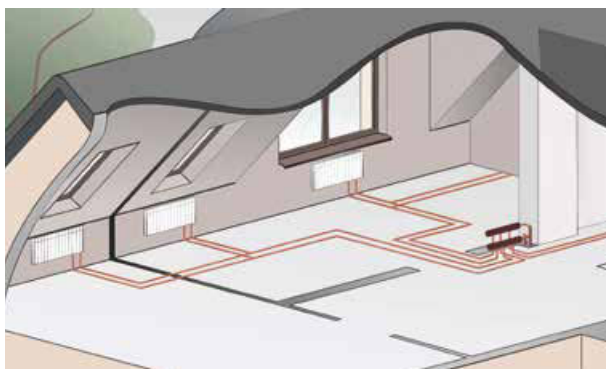
Kollektor – kolmikusüsteem küttepaigaldises
