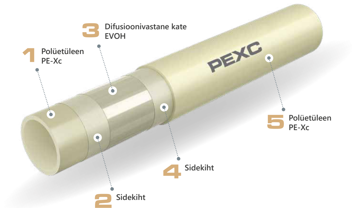
Difusioonivastase kattega PEXC toru ristlõige
