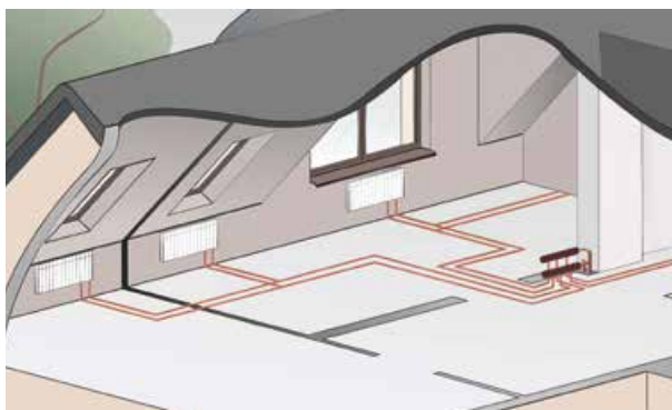
Kollektor – kolmikusüsteem küttepaigaldises
