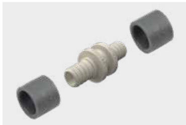
Joon. 50. KAN-therm ultraLINE-liitmik PEXC, PERT² ja PERTAL² torudele läbimõõduga 14 × 2, 16 × 2,2, 20 × 2,8, 25 × 2,5 mm
