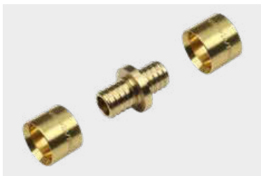
Joon. 49. KAN-therm Push-liitmik PEXC, PERT ja bluePERT torudele läbimõõduga 12 × 2, 14 × 2, 18 × 2, 18 × 2,5, 25 × 3,5 mm.
