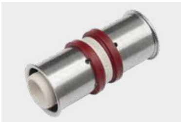
Joon. 51. KAN-therm ultraPRESS-liitmik PERTAL, PEXC, PERT, bluePERT ja bluePERTAL torudele läbimõõduga 14 × 2, 16 × 2, 20 × 2, 25 × 2,5 mm.
