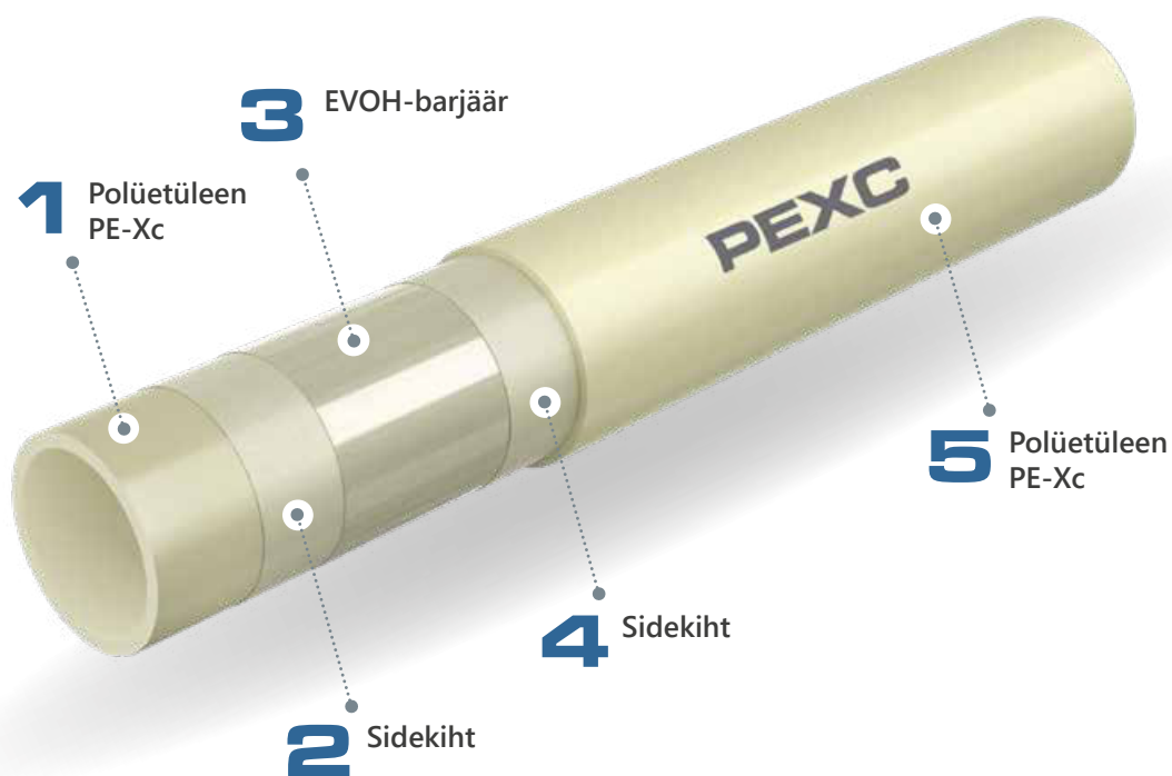
Joon. 48. EVOH-barjääriga KAN-therm PEXC toru ülesehitus
