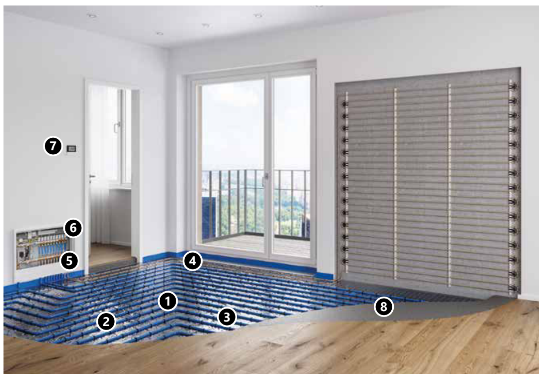
Joon. 40. KAN-therm veepõhise pinnakütte- ja jahutussüsteemi komponendid
