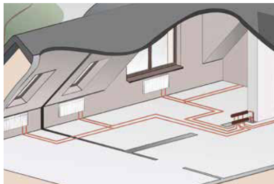
Kollektor – kolmikusüsteem küttepaigaldises
